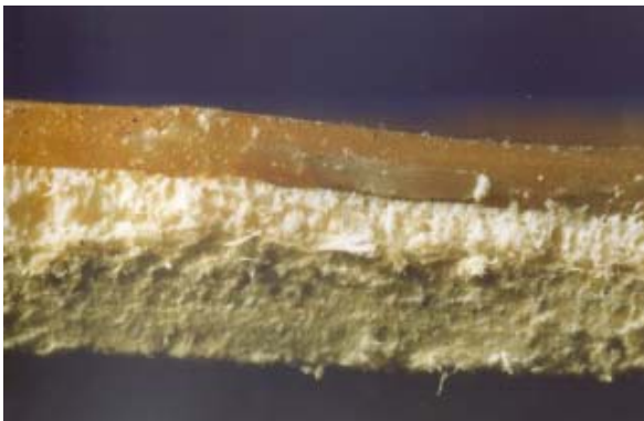
In Bahnen verlegter Bodenbelag im Querschnitt. Man sieht drei Lagen, zuunterst den Asbestkarton, Foto: SA
