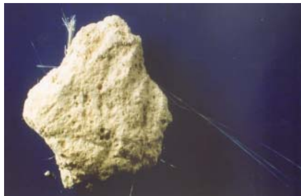
Mörtel aus einer asbesthaltigen Rohrisolation mit sichtbaren Asbestfaserbündeln, Foto: SA
