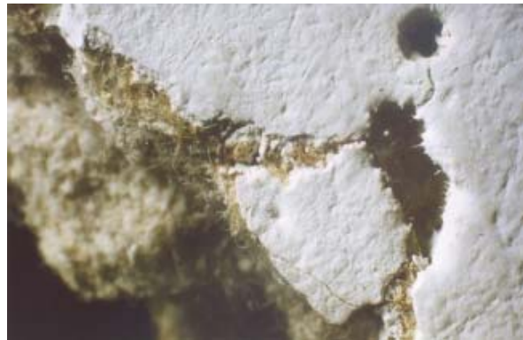
Vergrosserung einer Akustikplatte mit typischem Loch und Fasern aus Mineralwolle und Asbest, Foto: SA
