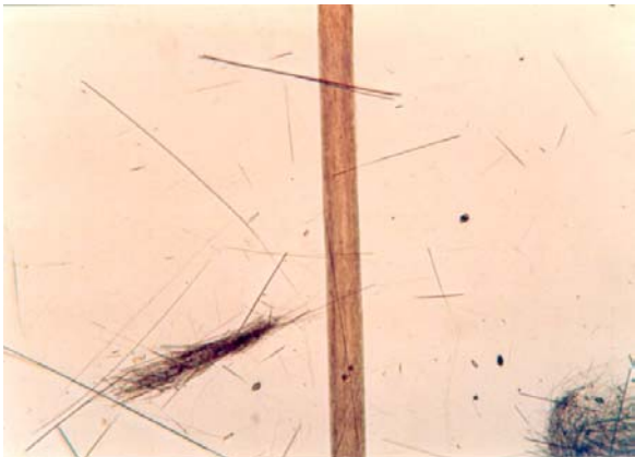
Asbestfasern und menschliches Kopfhhaar, Foto: OF, IST
